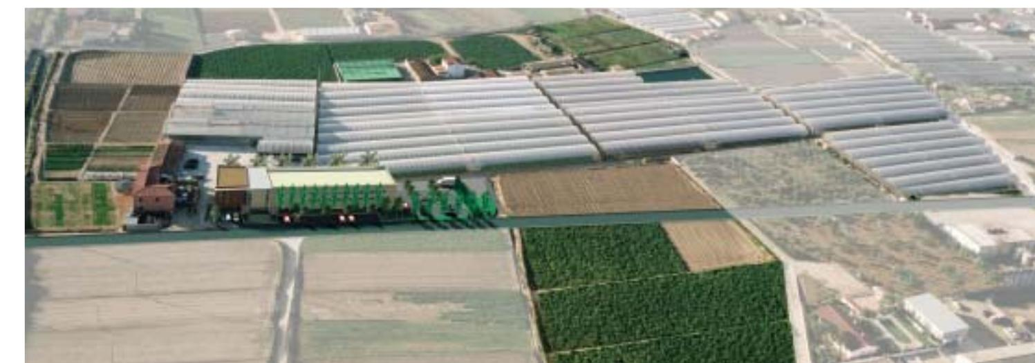
La ventilación más usual es la ventilación cenital, instalada en el techo del invernadero, accionada por cremalleras cada 2 ó 2,5 m, según se trate de módulo 4 ó módulo 5, que puede automatizarse mediante la incorporación de un motorreductor y nuestra centralita de control climático ININSACLIM®. Otro tipo es la ventilación enrollable instalada en los laterales y/o en los frontales del invernadero y con posibilidad de motorizarse y automatizarse de igual forma que la descrita anteriormente.
